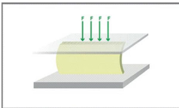
Fig. 30. ECT test
