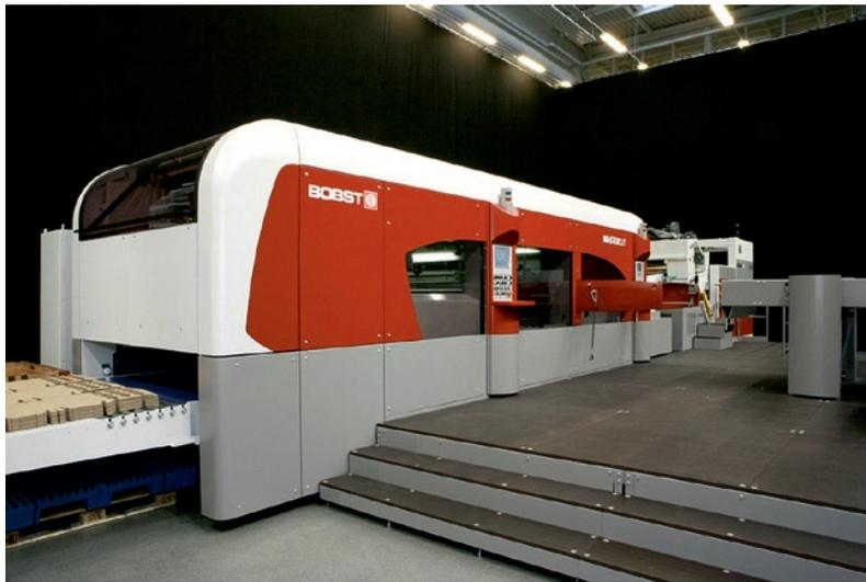
Fig. 26. Flat Bed Die Cutter
