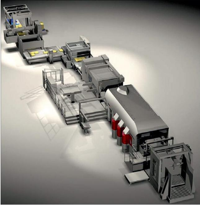
Fig. 25. Inline Flexo printer
